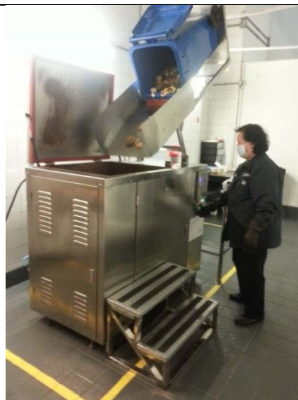
廚餘機操作員啓動廚餘機及監察運作正常
